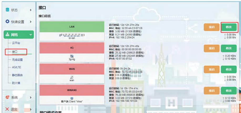
3.3 此处LAN口地址IP必须要跟需要连接的PLC在同一网段不冲突，否则无法连接 PLC。（连接触摸屏或者某一些PLC，建议设置网关，路由网关跟远程模块此处LAN网关地址一致）
